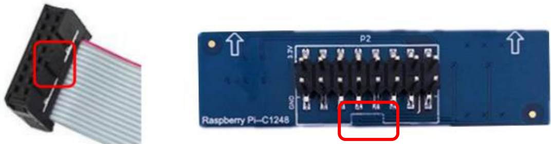
图 13 16PIN 排线连接器凸起与排针缺口方向
