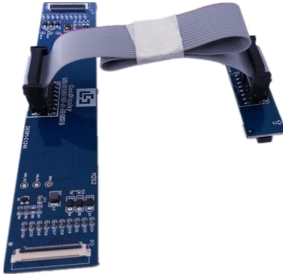
图 12 Raspberry Pi-C1248 与 DESPI-C1248 连接方式
