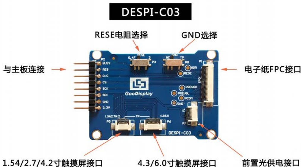
图 2 转接板 DESPI-C03 功能图
