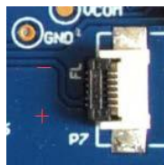
图 5 前置光板与转接板连接方式
