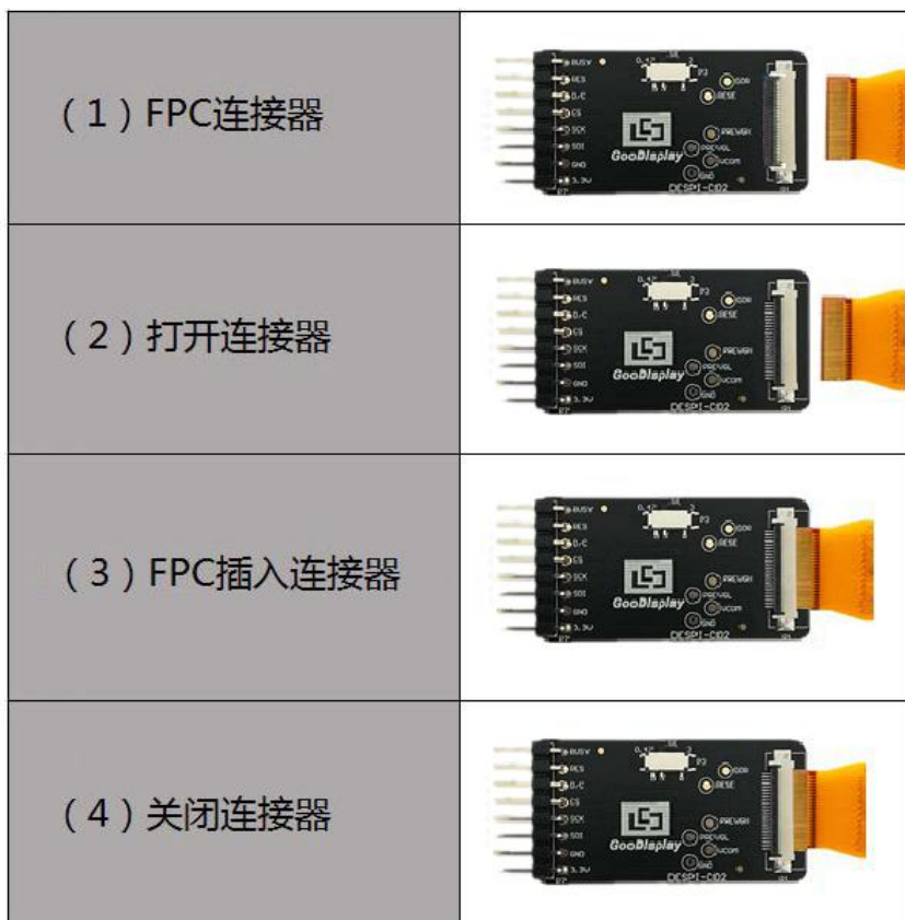
图 4 电子纸与转接板连接方式
