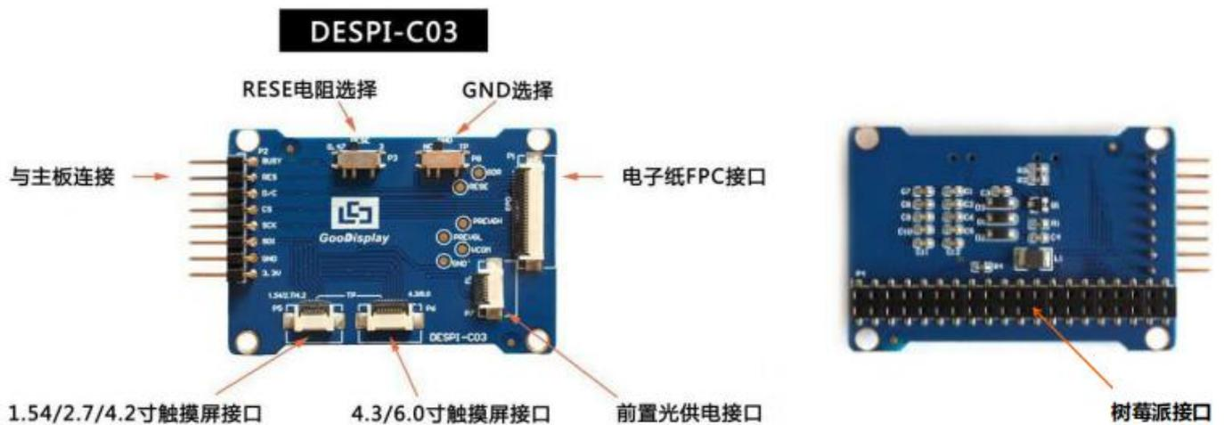
图 2 转接板 DESPI-C03 功能图
