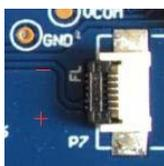
图 5 前置光板与转接板连接方式
