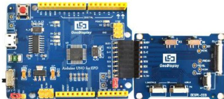
图 3 转接板与主板连接方式
