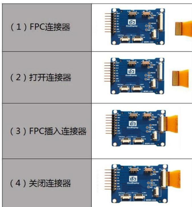
图 4 电子纸与转接板连接方式
